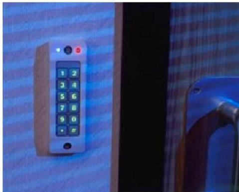
Il kit AX50 è un sistema compatto di controllo degli accessi di un singolo varco. AX50 opera in modalità offline, senza collegamento a PC.
